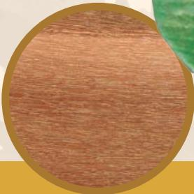
En la Amazonia su uso principal es para postes por su larga duración. Se usa en construcciones pesadas, traviesas para ferrocarril, construcción marina sobre el agua, parquet para pisos, columnas, puentes, chapas e implementos agrícolas y mangos de herramientas. La madera es de excelente calidad, dura y muy pesada. La albura de la madera es amarilla y el duramen pardo oscuro. Es difícil de trabajar, aunque se obtienen buenos acabados.
