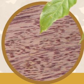
La madera del achapo no se deforma o se raja si es apilada de modo correcto, es moderadamente pesada, se seca rápidamente al aire libre; es una madera difícil de inmunizar, sin embargo es altamente resistente en contacto con la intemperie. Es fácil de trabajar con maquinas dando buenos acabados, excepto en el moldurado.
