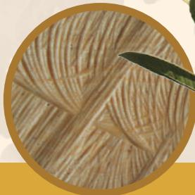
La madera es dura y pesada, pero a la vez extremadamente elástica. El duramen en estado seco es amarillo pálido a parduzco. La madera es utilizada en construcciones de sustentación, construcciones internas, chapas, pisos, parquet, durmientes, en la construcción de balsas y en la artesanía.
