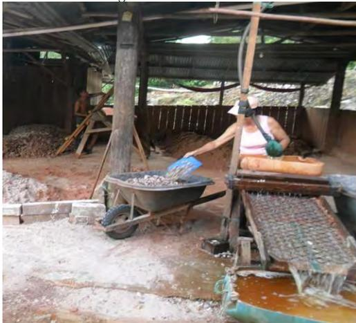
Criba empleada en la separación del material.
