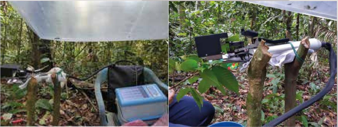
Figura - Instalación del CIRAS 3 en el área de trabajo (a) y pinza del CIRAS 3 durante la toma de datos (b)
