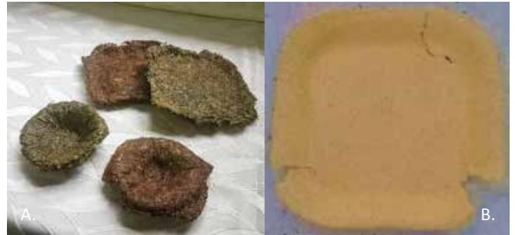
**Figura 3.** Ensayos de biopolímeros semi-rígidos a partir de A. calceta de plátano (color café) y hojas de yuca (color verde), y B. Bioempaques comerciales a partir de fique. Fotos: Clara P. Peña-Venegas.
