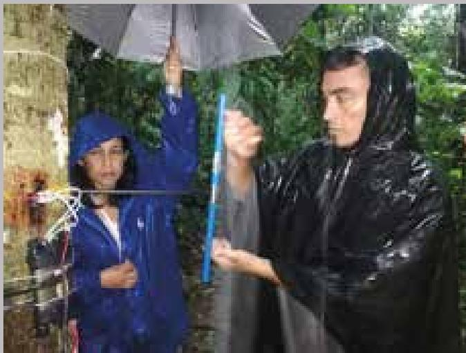
Instalación del sensor de flujo masico
